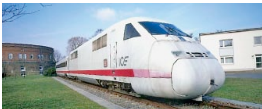
Bild 3: Triebkopf des ICE V mit einem Mittelwagen
