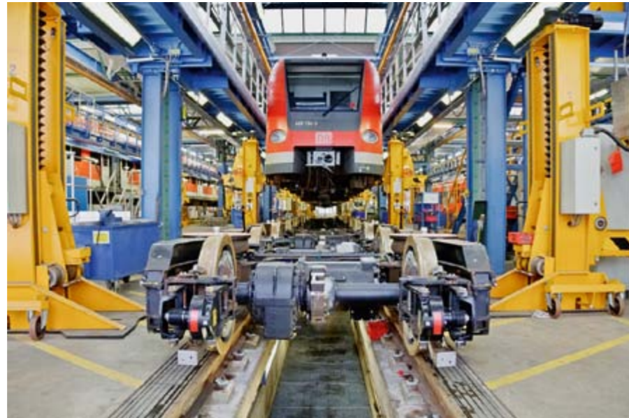
Bild 7: ET 425 vor dem Aufsetzen auf die Drehgestelle
