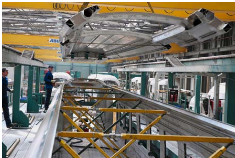
Bild 1: Aufsetzen der Dach-Baugruppe auf den Wagenkasten-Rohbau eines ICE 3
