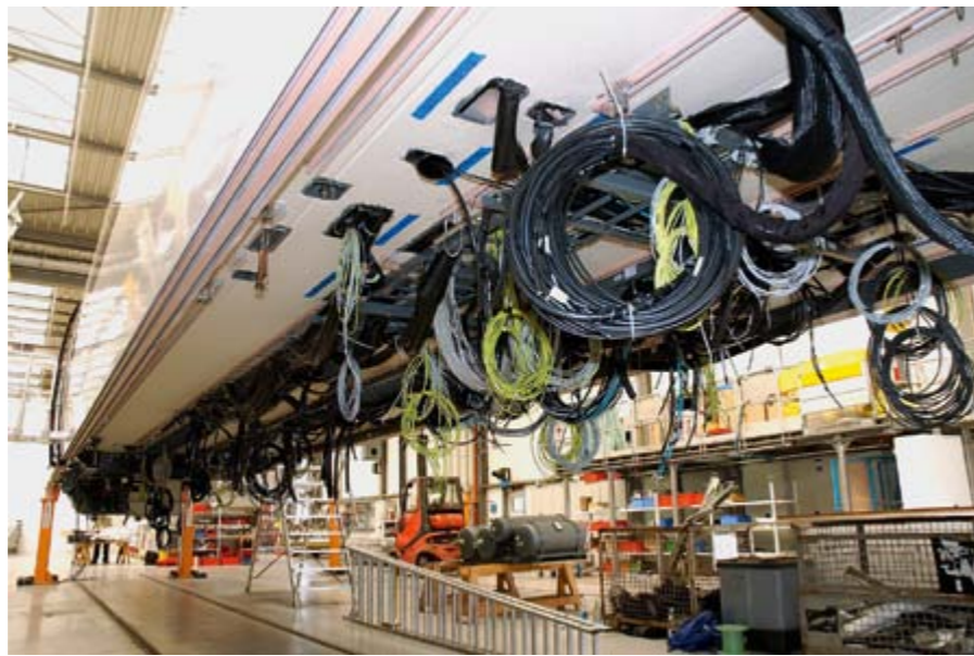
Bild 3: Wagenkasten eines Velaro D auf dem Montagestand
