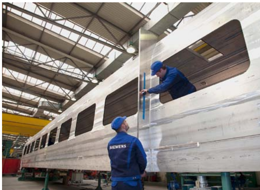
Bild 2: Maßkontrolle am Wagenkasten-Rohbau eines Velaro D
