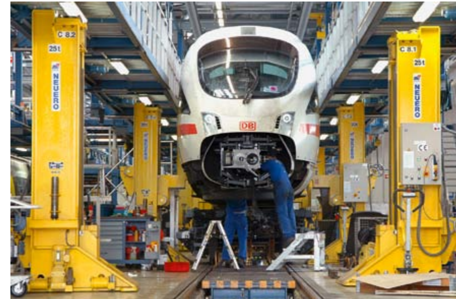
Bild 9: Instandhaltungsarbeiten am Kupplungskopf eines ICE-T
